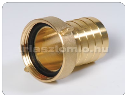
Réz tömlőcsonk belső menettel Lapos tömítőfelülettel, forgatható füles anyával
